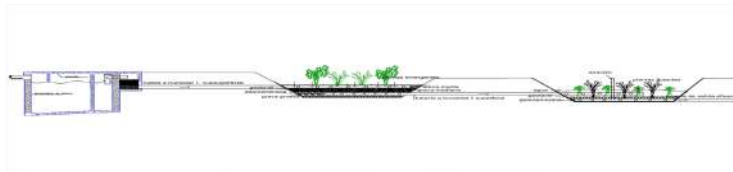
Imagen 6. Vista lateral de un corte del sistema de humedales y la fosa séptica
